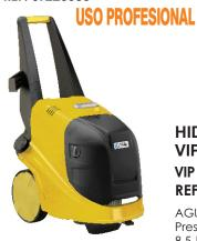
Presión de trabajo: 150 bar Caudal máx.: 8,3 l./m. R.P.M: 2800 Peso: 52.8 Kg. Dimensiones: 510x770x700 mm.
